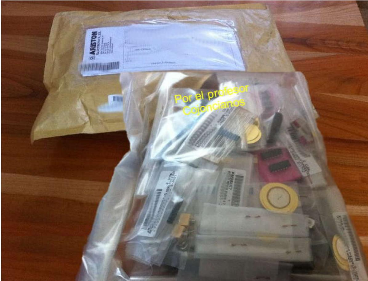
No tendrás problema para diferenciar las piezas porque cada una viene en bolsa individual con el código. El problema podrías tenerlo si mezclas las resistencias de diferentes valores antes de soldar por descuido. En ese caso si tienes un polímetro no hay problema. Si no lo tienes puedes recurrir a la tabla de códigos de colores:
